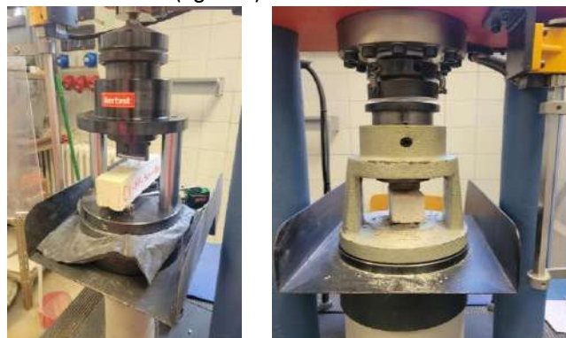
Figure 1: Ensayo a flexión y compresión. (Source: propia)
